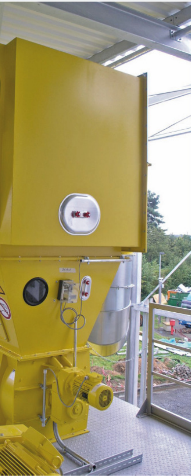
Filteranlage mit Presse.
