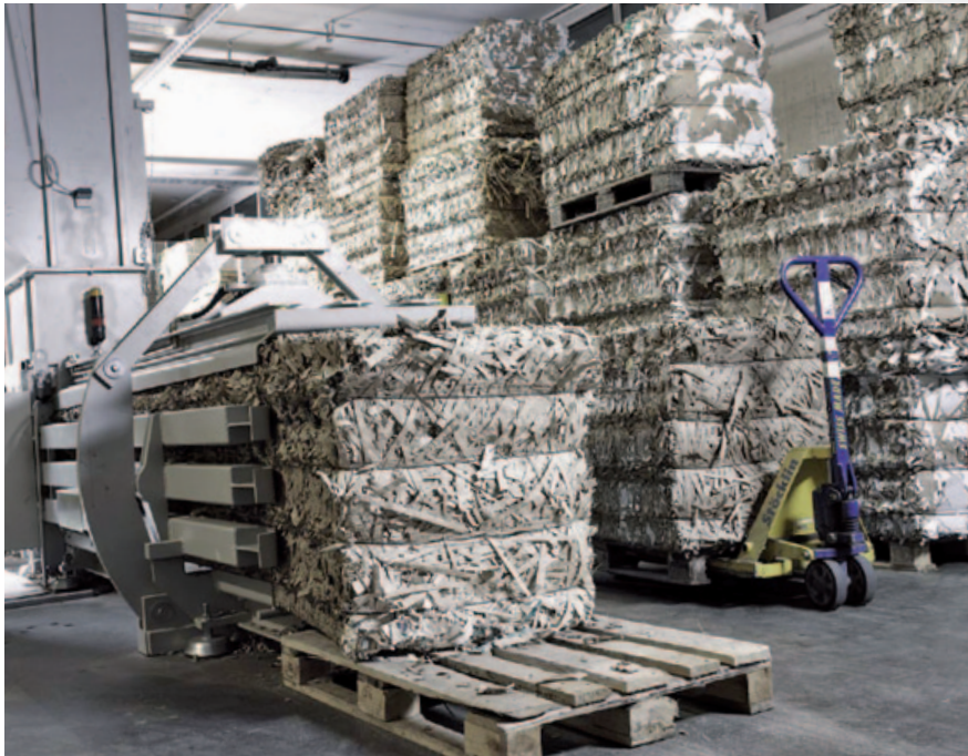
HSM: Die vollautomatische Kanalballenpresse VK 4212 eignet sich besonders für Anwendungen mit mittlerem Materialaufkommen. Verpresst werden können z. B. Papier, Randabschnitte von Druck- oder Stanzmaschinen, Kartonagen, geschreddertes Material und Folien.
