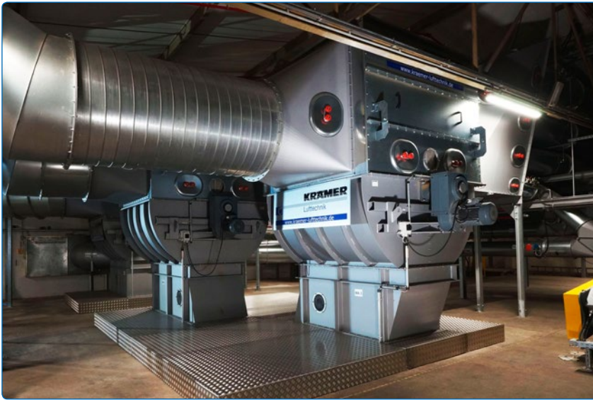
Abscheidersystem für sortenreine Trennung des Papierschnitts
